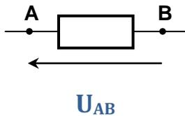
**Remarques** : Le sens de la flèche est choisi arbitrairement ou imposée sur le schéma.
